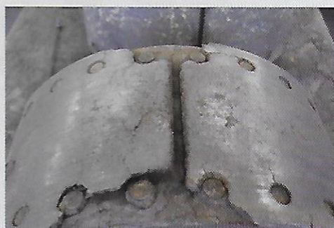
Dit is wat Rekos het meest tegenkomt in de offroad-sector. Afgebrokkelde of compleet afgeschoven remschoenen.
