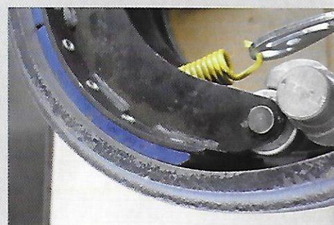
Bij remrevisie wordt de remvoering gelijmd plus geklonken. Daarna wordt de voering op maat afgedraaid voor een precieze aansluiting.
